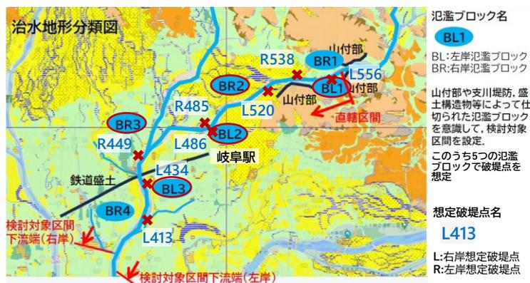
S I +では、岐阜大による氾濫・浸水シミュレーション結果を、事前に準備した25mメッシュレベルの推計人口や推計資産評価額等の情報<sup>4</sup>と重ね合わせて分析することにより、浸水に伴う人的・経済的な被害指標の詳細な分析<sup>5</sup>や地域全体としての被害量の集計、気候変動による影響評価を行いました。
