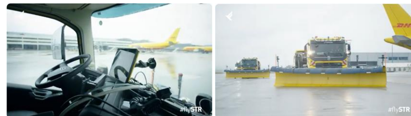
図表 3-16 空港における自動運転除雪車の実証実験
